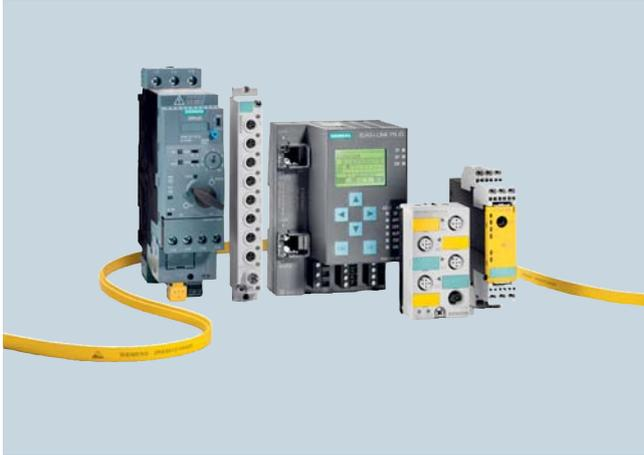
Das Aktuator-Sensor-Interface ist ein offenes, herstellerunabhängiges Bussystem. Über eine ungeschirmte 2-Draht-Leitung werden Aktuatoren und Sensoren mit speicherprogrammierbaren Steuerungen verbunden – bei gleichzeitiger Übertragung von Daten und Energie.
