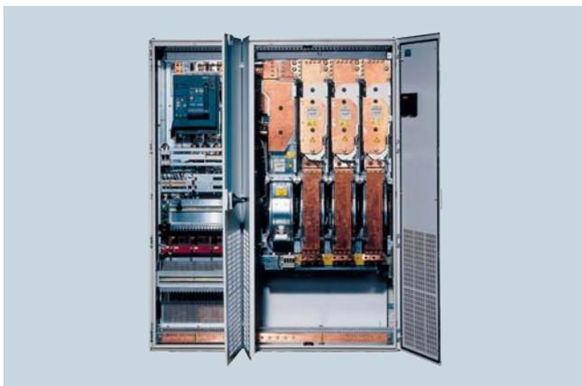
Die Frequenzumrichter SINAMICS G150, G130, S150 werden zur Drehzahlregelung von großen Motoren mit Leistungen von 75 kW bis 1200 kW eingesetzt. Sie sind weitgehend identisch aufgebaut (Regelungsbaugruppe, Bedienfeld, Leitungsteile) und können somit in gemeinsamen Kursen behandelt werden.
